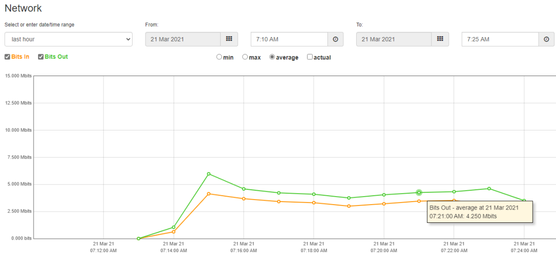
Figura 18. Ancho de banda utilizado en el servicio de streaming en IPTV con conectividad L3VPN en Wowza Streaming Engine.
