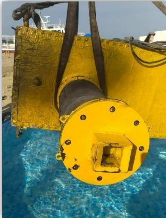
Figura 32. Prueba de infiltración del Sistema Mecánico. Fuente. Gecoproes SAS.
