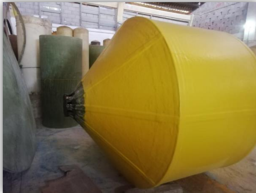
Figura 29. Tanque Boya del Prototipo. Fuente. Gecoproes SAS.
