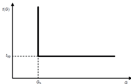
Figura 36. Operación de función de protección 50. BSI (2009). Tomado de Measuring relays and protection equipment Part 151: Functional requirements for over/under current protection.
