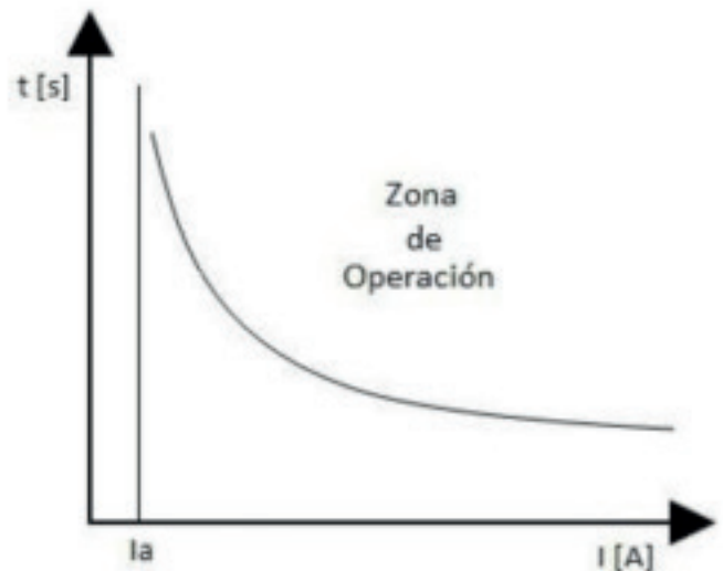
Figura 37. Operación de función de protección 51. BSI (2009). Tomado de Measuring relays and protection equipment Part 151: Functional requirements for over/under current protection
